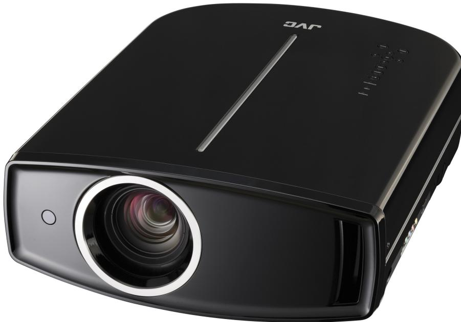
3x 0.7"-os Full HD-s D-ILA chippek Bemeneti jel fogadó képesség: 1080p Valós FULL DHD felbontás 1920x1080 200W UHP (ultra high-pressure mercury) lamp (lamp life: approx. 3000 hours in Normal mode) Vetítési méret:60" tól 200"-ig Vetítési távolság: 3.01m től 6.08m-ig (100") Terminals: RS232C x 1, HDMI x 2 (v.1.3), Component x 1, S-Video x 1, Composite x 1, PC x 1, Trigger x 1
